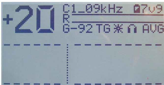
При следующем длительном нажатии на эту кнопку, высветится режим (**G2**), это режим вектографа, без накопления. Сигнал без накопления будет меняться на дисплее каждый раз, когда будет появляться сигнал от датчика
