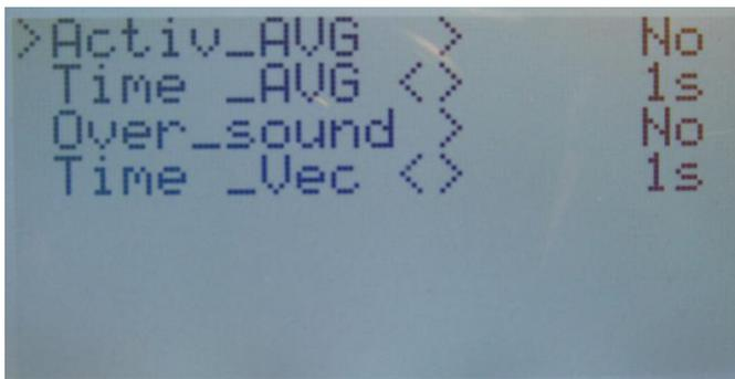
Первая строчка (**Activ\_AVG**), включение/выключение АРУ (автоматическое регулировка усиление). Включение/выключение кнопкой (**→**). На сильно замусоренных местах, эту опцию желательно отключать, что бы не потерять чувствительность к мелким целям.
