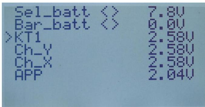
Первая строчка (Sel\_batt), калибровка питающей батареи. Мультиметром, замеряем напряжение на самой батарее прибора, и кнопками (**←→**), устанавливаем такое же напряжение в строчке (**Sel\_batt**). При полном сбросе, калибровка не сбрасывается.
