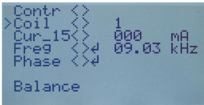
Третья строчка (Cur), установка тока ТХ, для конкретного профиля. Ток измеряется в миллиамперах. Напротив надписи (**Cur**), число в шагах регулятора тока. Число 31- максимальный ток. Ток сохраняется автоматически, для каждого профиля.
